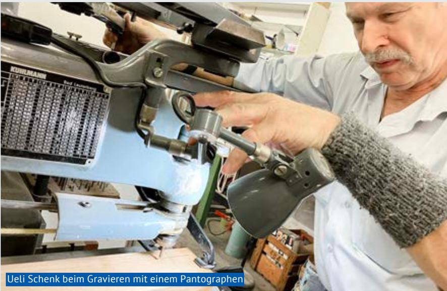
Ueli Schenk beim Gravieren mit einem Pantographen
